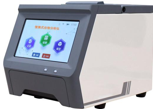
HYM-1200便携式谷物分析仪适用于大豆、小麦、玉米、稻谷等谷物的收购、储存、加工等多个环节，实现快速、无损、多指标定量检测分析，为谷物品质鉴定提供快速检测方法。仪器可应用于实验室、车间、野外现场等不同场合。
